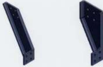
شكل 23. نموذج جسر يستخدم مع هيكل شاحنة ذو مقطع أي (C-section beam)
