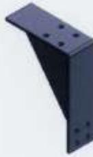
شكل 22: نموذج جسر يستخدم مع هيكل شاحنة ذو مقطع أي (I-section beam)
